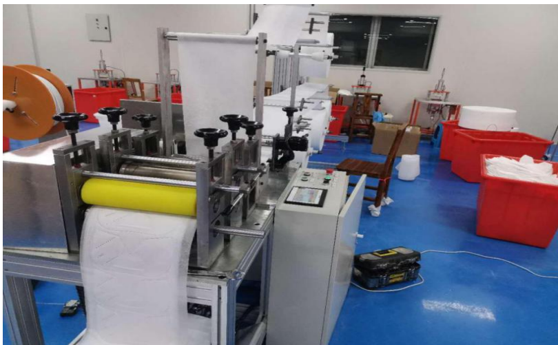
图 6.1 中心开发的 KN95 型立体口罩出片机
