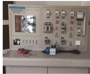
图 5-2 低压电工安全操作考试系统
