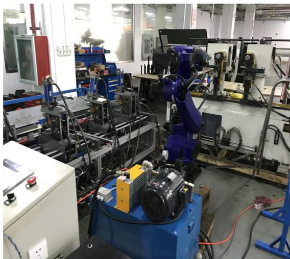
图 45：90° 钻孔切割自动化设备
