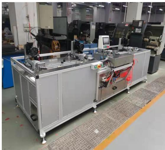
图 46：全自动冲弯管机器人工作站
