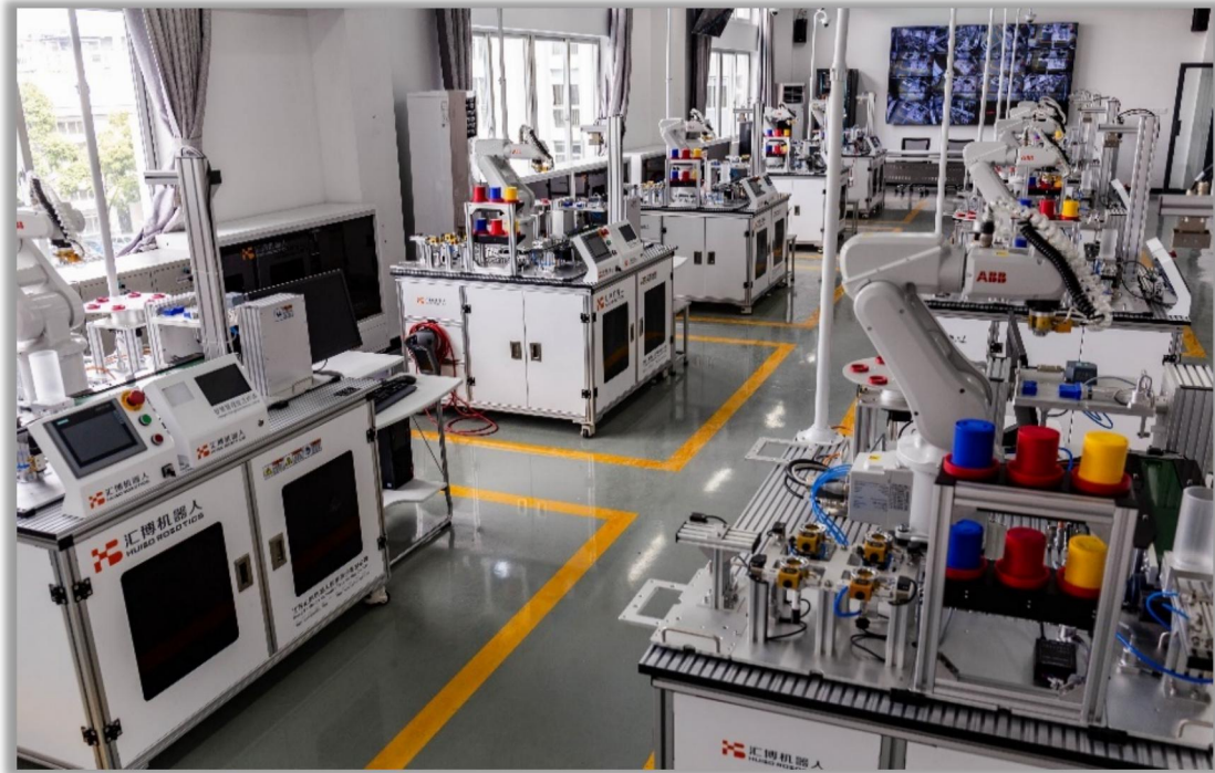
图 8-1 实训室安全警戒线及安全通道设置
