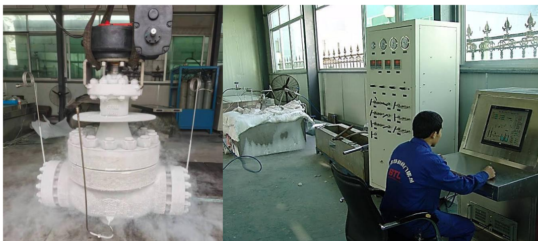
图 4-3 大口径高压高密封深冷球阀低温试验
